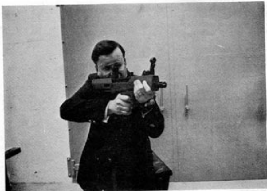
Eino Tubin provriktar prototypen till en 5,56 mm k-pist från den statliga vapenfabriken i Bern. Vapnet har mekanismen inbyggd i kolven, och blir därigenom kompakt.
